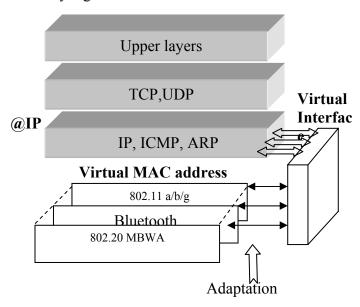
FIG. 1: VIRTUAL INTERFACE ARCHITECTURE
