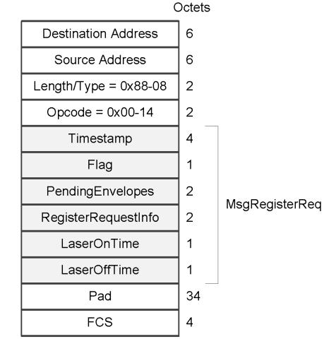
Figure 144–14—REGISTER\_REQ MPCPDU
